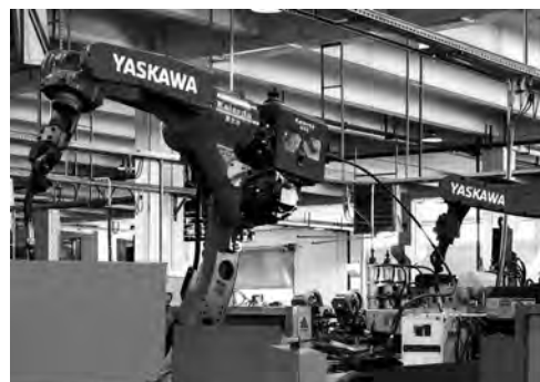
Автоматизована зварювальна лінія
